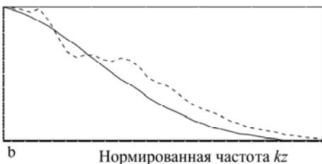
Рис. 5. Изображение объекта, рассчитанное по формуле (6) слева и по сумме всех кадров справа (рис. 5а) и его ЧКХ (пунктир на рис. 5б)). Сплошная линия на рис 5б - ЧКХ усредненного изображения, рассчитанная по (1).
